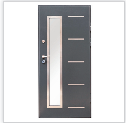
DRZWI ZEWNĘTRZNE LEKKIE WZMOCNIONE DONIMET DL1.1. Drzwi wejściowe zewnętrzne, wzmocnione klasa RC2N. Wymiar: dowolny. Konstrukcja: stalowa. Wypełnienie: wełna mineralna. Wyposażenie: 3 łożyskowane zawiasy, 3 blokady przeciwwyważeniowe, zamek podklamkowy klasy II i zamek dodatkowy klasy 2. Wykończenie: lakierowanie proszkowe, okleina drewnopodobna PVC, lakierowana płyta MDF, płyta sklejkowa forniowana naturalną okleiną dębową.
