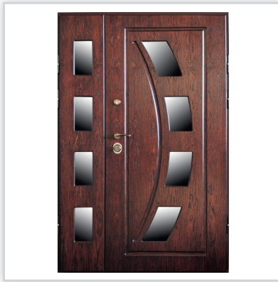
DRZWI ANTYWŁAMANIOWE ZEWNĘTRZNE DL1.4/2 DRAGON. Drzwi wejściowe zewnętrzne, antywłamaniowe klasa RC 4. Wymiar: dowolny. Konstrukcja: stalowa. Wypełnienie: wełna mineralna. Wyposażenie: 6 łożyskowanych zawiasów, 6 blokad przeciwwyważeniowych, zamek podklamkowy rozporowy klasy 6, kantrygły. Wykończenie: lakierowanie proszkowe, okleina drewnopodobna PVC, lakierowana płyta MDF, płyta sklejkowa forniowana naturalną okleiną dębową.
