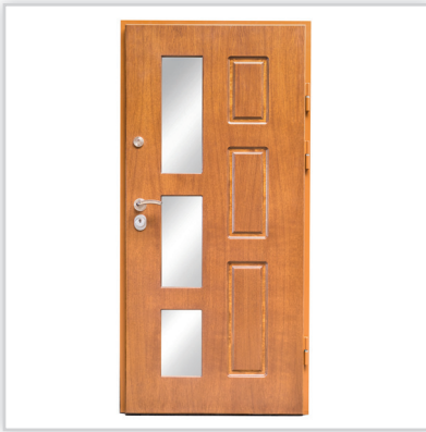
DRZWI ANTYWŁAMANIOWE ZEWNĘTRZNE DONIMET DC3.1. Drzwi wejściowe zewnętrzne, antywłamaniowe klasa RC4. Wymiar: dowolny. Konstrukcja: stalowa. Wypełnienie: wełna mineralna. Wyposażenie: 3 łożyskowane zawiasy, 3 blokady przeciwwyważeniowe, zamek centralny rozporowy klasy 7. Wykończenie: lakierowanie proszkowe, okleina drewnopodobna PVC, lakierowana płyta MDF, płyta sklejkowa forniowana naturalną okleiną dębową, obłożenie drewnem sosnowym lub dębowym.
