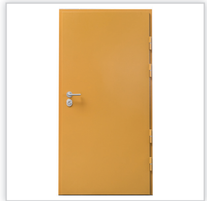
DRZWI ANTYWŁAMANIOWE PRZECIWPÓŻAROWE DONIMET DC3.1. PP60. Drzwi przeciwpożarowe klasy C i RC4. Odporność ogniowa: EI, 60. Wymiar: dowolny. Konstrukcja: stalowa. Wypełnienie: wełna mineralna oraz płyty gipsowe. Wyposażenie: 4 łożyskowane zawiasy, 3 blokady przeciwwyważeniowe, zamek centralny rozporowy klasy 7, samozamykacz. Wykończenie: lakierowanie natryskowe, okleina drewnopodobna PVC, lakierowana płyta MDF, płyta sklejkowa forniowana okleiną dębową.
