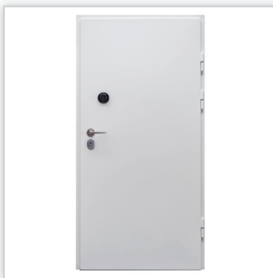
DRZWI KANCELARYJNE DONIMET DC3.1. KT-M. Drzwi kancelaryjne klasa C i RC4. Wymiar: dowolny. Konstrukcja: stalowa. Wypełnienie: wełna mineralna. Wyposażenie: 3 łożyskowane zawiasy, 3 blokady przeciwwyważeniowe, zamek centralny rozporowy klasy 7, zamek dodatkowy sztyfowy odporny na prześwietlenie, uchwyty do plombowania. Wykończenie: lakierowanie proszkowe, okleina drewnopodobna PVC, lakierowana płyta MDF, płyta sklejkowa forniowana okleiną dębową.
